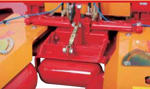
Höhenverstellbare Laufwalze mit Gewindespindel
