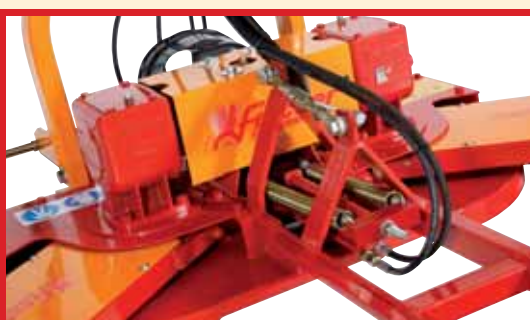
Hydraulischer Schwenkarmeinzug beidseitig mit einem Zylinder
