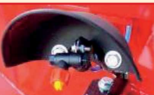
Schwenkscheiben mit Herbizidköpfen in Höhe und Tiefe verstellbar
